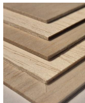
Slika 1 Način slaganja višeslojne drvene ploče
